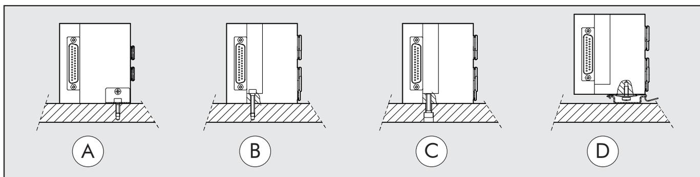
A: Par la patte de fixation de la plaque d'alimentation code 0227300300 (livrée avec la plaque d'alimentation).
